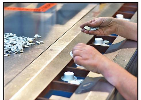
Las máquinas empaquetadoras en bolsas se combinaron en una isla de empaquetado. Este es el punto de destino de los artículos que se deben empaquetar junto con los accesorios provistos por ESTB. Los productos se someten aquí a un proceso de empaquetado semiautomático. Inmediatamente después, los artículos empaquetados en bolsas con base se envían utilizando una solución intralogística.
